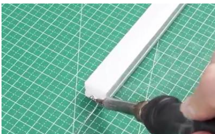
4. Prestagnare le piazzole (si consiglia l'utilizzo di stagno senza piombo con flussante no-clean). Non superare mai il tempo massimo di contatto di 2 secondi a 350°C.
