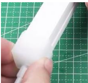
7. Assicurarsi che tra il tappo di chiusura e la guaina esterna non ci siano aree vuote. Pulire con un panno il silicone in eccesso
