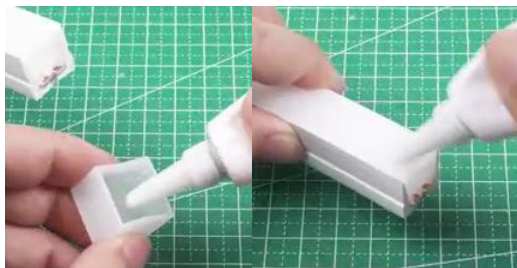
8. Ripetere il punto 6 e 7 per il tappo di chiusura dell'estremità opposta tenendo presente che non ci sarà alcun cavo di alimentazione passante.
