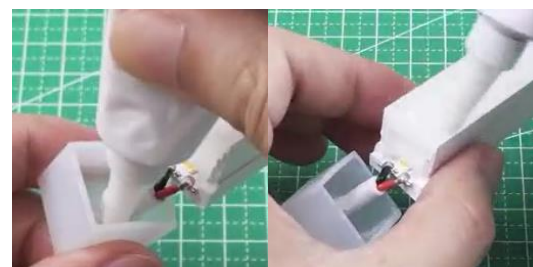
6. Riempire abbondantemente il tappo con del silicone ed applicarlo in minor quantità anche sulle 4 facce della guaina esterna della striscia LED. Portare il tappo di chiusura a battuta della guaina affinché il silicone in eccesso sbordi dai 4 lati.
