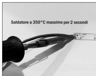
Figura 4. Saldatura dei cavi Utilizzare stagno senza piombo
