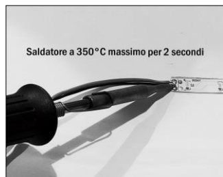
Figura 4. Saldatura dei cavi Utilizzare stagno senza piombo
