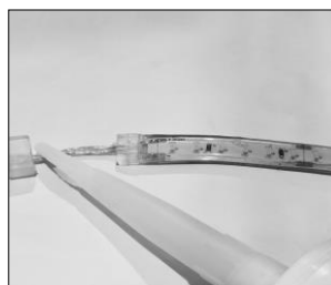
Figura 5a, 5b e 5c. Identificare la sezione di taglio più vicina alla lunghezza desiderata, inserimento tappo di chiusura e aggiunta di silicone per ripristinare il grado IP della striscia LED. NB: Riempire il tappo e la striscia LED di silicone o pasta siliconica specifica per circuiti stampati
