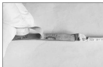
Figura 1. Rimuovere la pellicola protettiva dal nastro biadesivo
