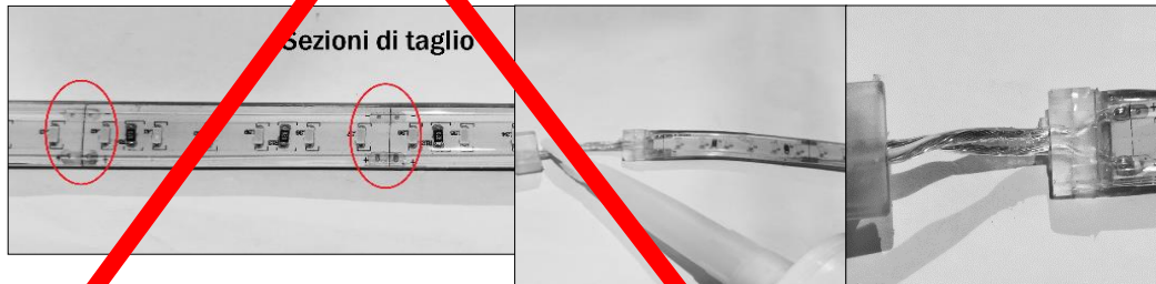
Figura 5a, 5b e 5c. Identificare la sezione di taglio più vicina alla lunghezza desiderata, inserire il tappo di chiusura e aggiunta di silicone per ripristinare il grado IP della striscia LED. NB: Riempire il tappo e la striscia LED di silicone o pasta siliconica specifica per circuiti stampati
