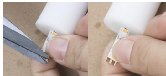
3. Tagliare una porzione di circuito della striscia LED superiore in prossimità del LED in modo tale da esporre le piazzole di saldatura sottostanti.
