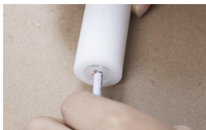
5. Riposizionare la striscia LED all'interno del tubo facendo attenzione di non piegarla.
