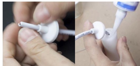
6. Inserire il tappo di chiusura facendolo passare attraverso il cavo di alimentazione tramite l'apposito foro. Applicare abbondante silicone in prossimità dell'estremità del tubo dove andrà appoggiato il tappo di chiusura. Il silicone in eccesso dovrà fuoriuscire durante la pressione del tappo sul tubo.
