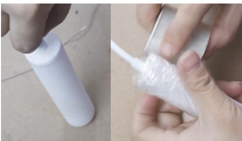
7. Una volta chiuso il tappo rimuovere il silicone in eccesso. Utilizzare della pellicola trasparente o similare per mantenere il tappo di chiusura in posizione in attesa che il silicone si asciughi completamente.
