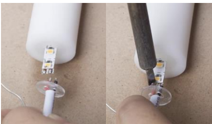
4. Prestagnare le piazzole (si consiglia l'utilizzo di stagno senza piombo con flussante no-clean). Inserire il tappo trasparente attraverso i cavi rosso/nero e procedere alla saldatura sulla striscia LED tenendo presente di non superare mai il tempo massimo di contatto di 2 secondi a 350°C.
