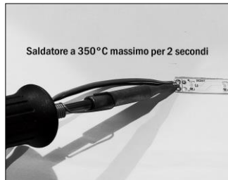
Figura 4. Saldatura dei cavi. Utilizzare stagno senza piombo
