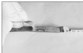
Figura 1. Rimuovere la pellicola protettiva dal nastro biadesivo
