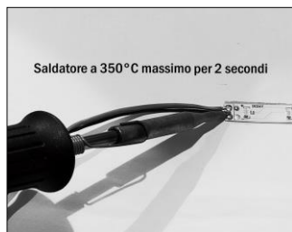
Figura 4. Saldatura dei cavi Utilizzare stagno senza piombo
