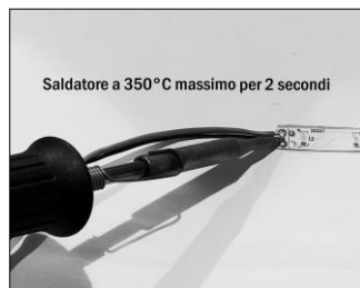
Figura 4. Saldatura dei cavi Utilizzare stagno senza piombo
