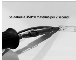
Figura 4. Saldatura dei cavi Utilizzare stagno senza piombo
