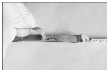
Figura 1. Rimuovere la pellicola protettiva dal nastro biadesivo
