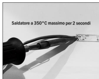
Figura 4. Saldatura dei cavi Utilizzare stagno senza piombo
