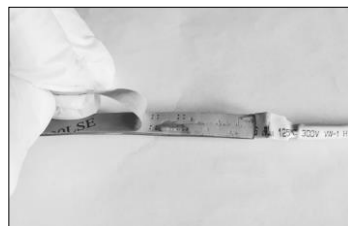
Figura 1. Rimuovere la pellicola protettiva dal nastro biadesivo
