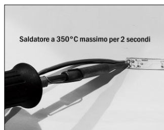
Figura 4. Saldatura dei cavi Utilizzare stagno senza piombo
