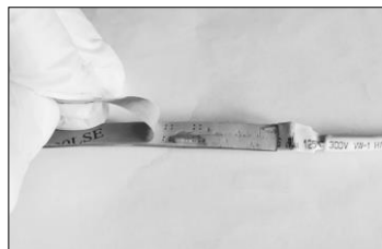
Figura 1. Rimuovere la pellicola protettiva dal nastro biadesivo
