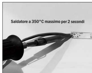
Figura 4. Saldatura dei cavi Utilizzare stagno senza piombo
