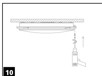
Fissare la plafoniera al soffitto/muro e avvitare il diffusore attraverso l'apposita vite
