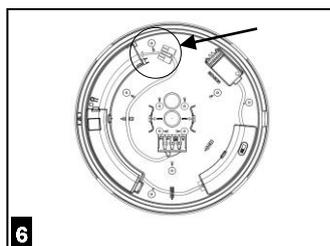
Collegare il cavo di alimentazione all'ingresso del modulo di emergenza. Fissare il cavo attraverso gli appositi fermacavi
