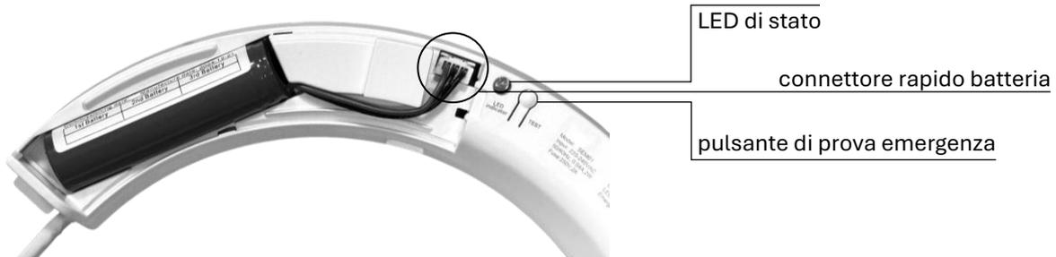
Nel caso si rendesse necessario la sostituzione del pacco batteria eseguire le seguenti istruzioni:
