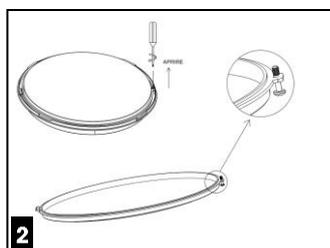
Rimuovere il diffusore svitando con un cacciavite l'apposita vite
