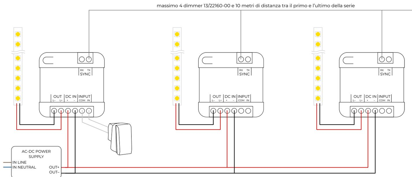
FIG. 4 - collegamento sincronizzazione "semplice" 13/22160-00 alimentatore singolo
