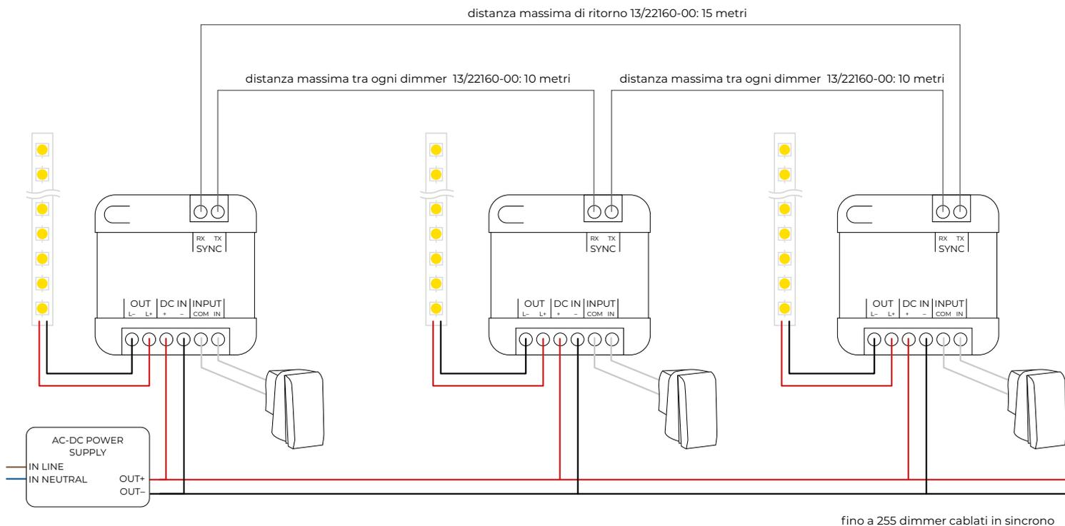
**FIG. 8** - collegamento sincronizzazione schema 3 alimentatore singolo
