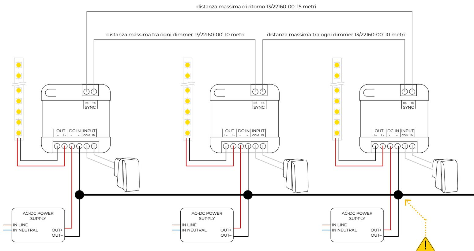
**FIG. 9** - collegamento sincronizzazione multi-master alimentatore multiplo 13/22160-00 fino a 255 dimmer cablati in sincrono
