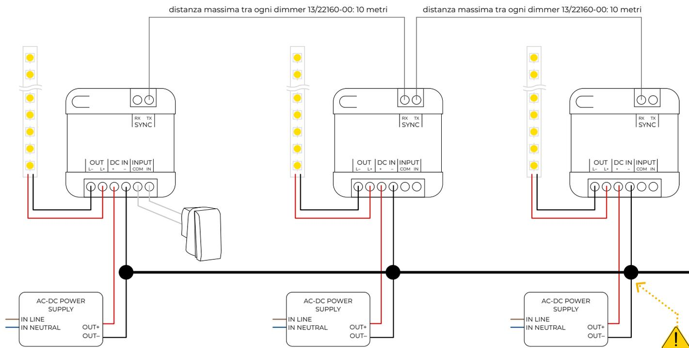
FIG. 7 - collegamento sincronizzazione schema 2 13/22160-00 alimentatore multiplo
