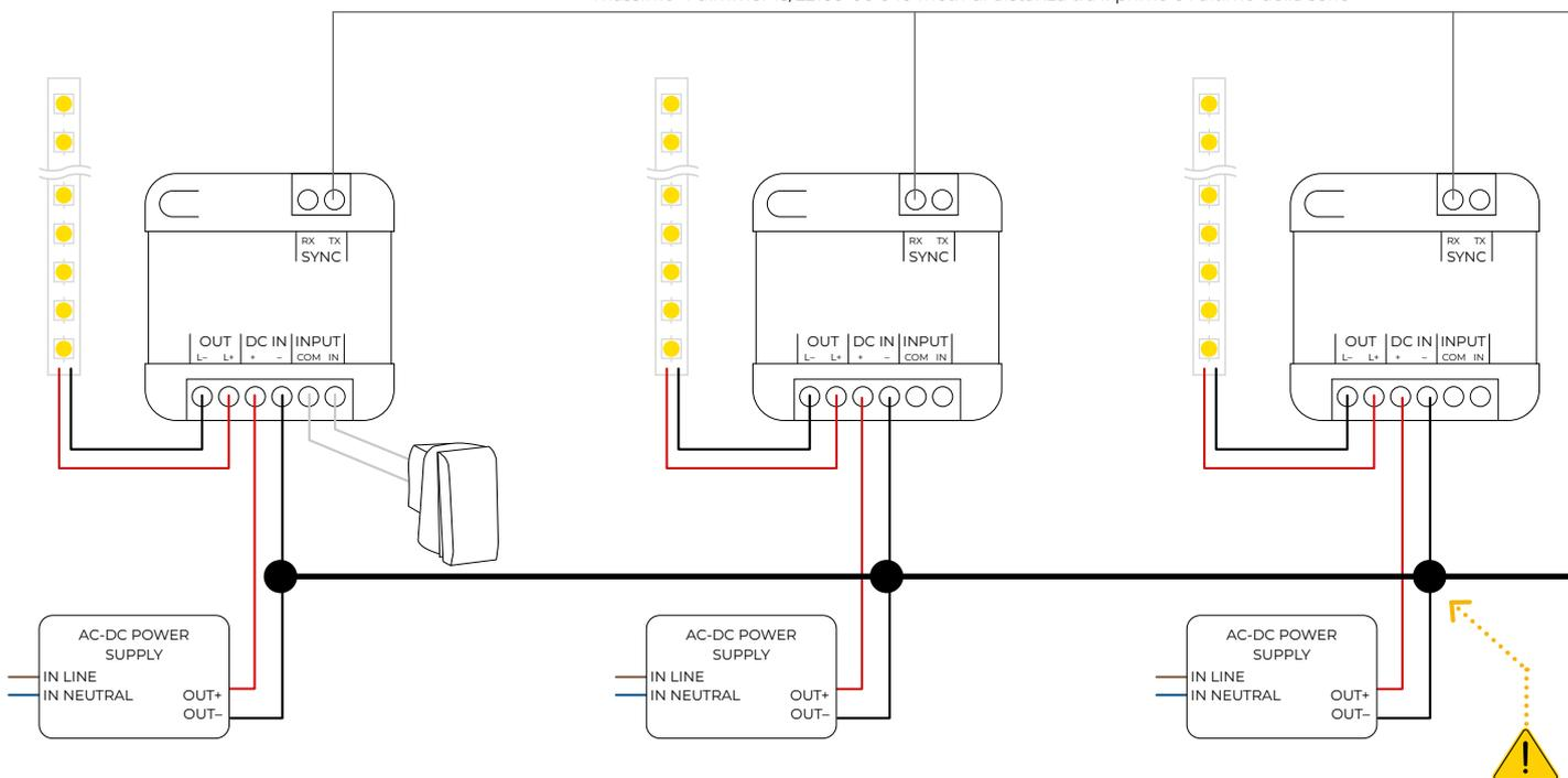
FIG. 5 - collegamento sincronizzazione "semplice" 13/22160-00 alimentatore multiplo
