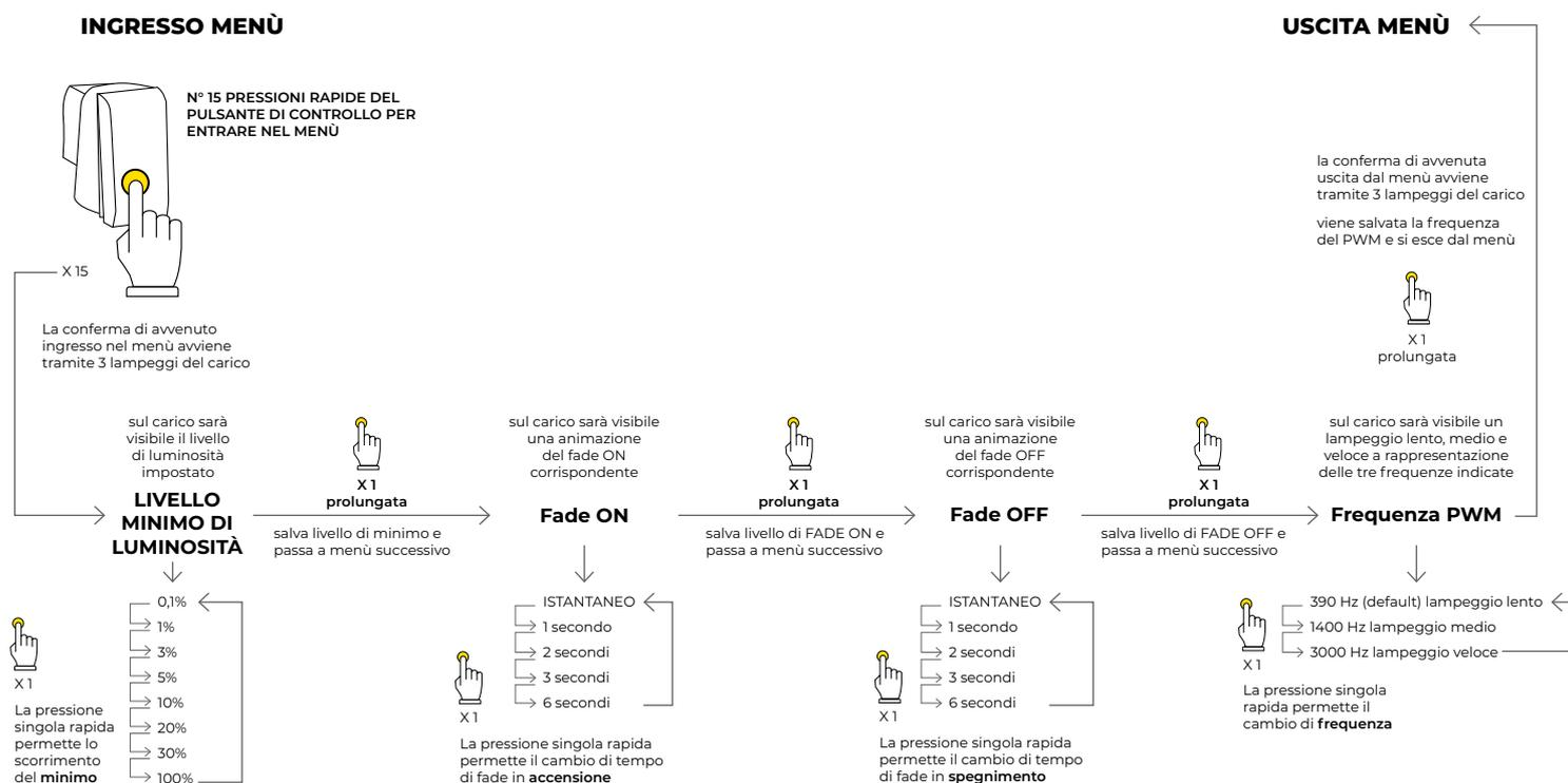
Il dimmer 13/22160-00 è dotato di un menù di configurazione dei parametri di funzionamento. L'ingresso nel menù di configurazione dei 4 parametri di funzionamento avviene con **15 pressioni rapide o più** del pulsante di controllo.
