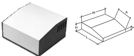
Ogni scatola viene assicurata da 4 viti autobloccanti e ha 4 piedini autoadesivi, il 515-0910 è anche dotato di fori per la ventilazione. Lo spessore del materiale è 1.2mm.
