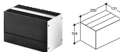
La costruzione consiste in due identici dissipatori che permettono l'alloggiamento di transistori con contenitore T03 e T066, i quali possono essere coperti da pannelli asportabili. Ideale per contenere apparecchi che richiedono grande dissipazione di calore. Fornita in alluminio anodizzato nero. Resistenza termica 1.2°C/W per watt.
