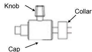
**Anello (collar):** Quando la Telecamera è installata sulla vite di montaggio, ruotare l'anello in senso antiorario per allentare o in senso orario per avvitare la vite di montaggio nella Telecamera IP.
