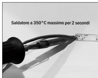
Figura 4. Saldatura dei cavi. Utilizzare stagno senza piombo
