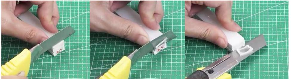
2. Per agevolare la saldatura dei cavi di alimentazione rimuovere la parte eccessiva di guaina con un cutter in modo tale da esporre le piazzole di saldatura.
