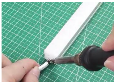
5. Facendo passare il cavo rosso/nero (non incluso) attraverso il tappo di chiusura; procedere con la saldatura di quest'ultimo sulle piazzole della striscia LED.
