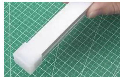
9. Aspettare la completa asciugatura del silicone, dalle 12 alle 24 ore dall'applicazione.
