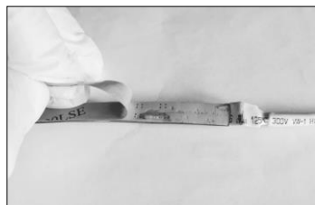
Figura 1. Rimuovere la pellicola protettiva dal nastro biadesivo
