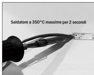
Figura 4. Saldatura dei cavi Utilizzare stagno senza piombo
