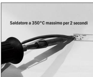
Figura 4. Saldatura dei cavi. Utilizzare stagno senza piombo
