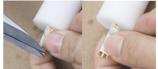
3. Tagliare una porzione di circuito della striscia LED superiore in prossimità del LED in modo tale da esporre le piazzole di saldatura sottostanti.
