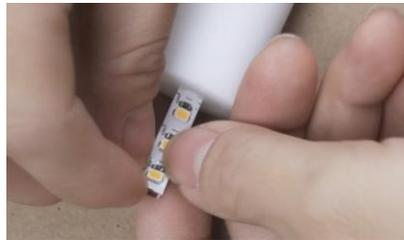
2. Per agevolare la saldatura dei cavi di alimentazione estrarre dal tubo una porzione della doppia striscia LED.
