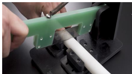
1. Tagliare la striscia in prossimità della misura desiderata, la serie 18/65060-00 può essere sezionata in qualsiasi punto lungo i 5 metri. Assicurarsi di effettuare un taglio netto.
