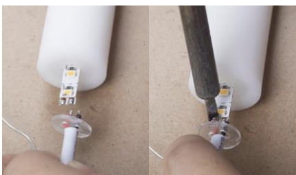
4. Prestagnare le piazzole (si consiglia l'utilizzo di stagno senza piombo con flussante no-clean). Inserire il tappo trasparente attraverso i cavi rosso/nero e procedere alla saldatura sulla striscia LED tenendo presente di non superare mai il tempo massimo di contatto di 2 secondi a 350°C.
