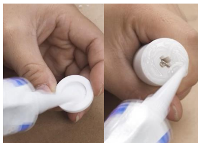
8. Ripetere il punto 6 e 7 per il tappo di chiusura dell'estremità opposta tenendo presente che non ci sarà alcun cavo di alimentazione passante.
