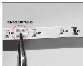
Figura 3a. Sezione di taglio di una striscia LED
