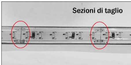
Figura 5a, 5b e 5c. Identificare la sezione di taglio più vicina alla lunghezza desiderata, inserimento tappo di chiusura e aggiunta di silicone per ripristinare il grado IP della striscia LED. NB: Riempire il tappo e la striscia LED di silicone o pasta siliconica specifica per circuiti stampati
