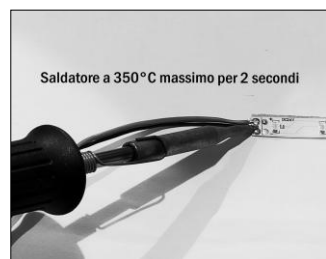
Figura 4. Saldatura dei cavi Utilizzare stagno senza piombo
