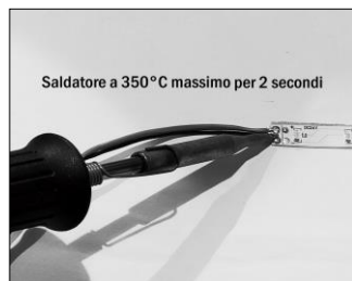
Figura 4. Saldatura dei cavi Utilizzare stagno senza piombo
