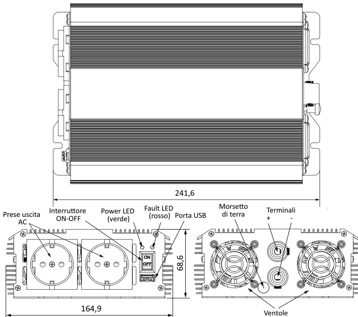
**ATTENZIONE:** Non invertite la polarità. Usate il cavetto rosso per connettere il terminale (+) alla batteria, poi usate il cavetto nero per connettere il terminale (-) alla batteria.
