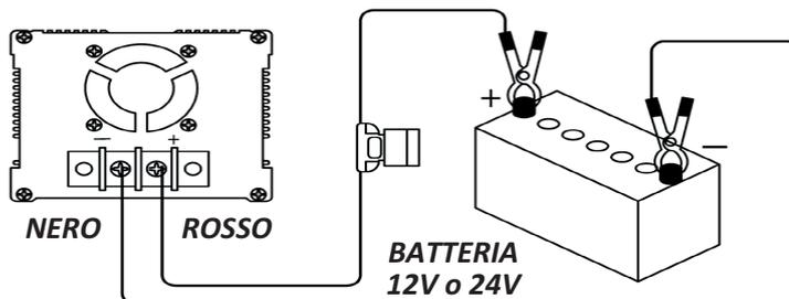
Nel connettere qualsiasi dispositivo, accertatevi che la potenza totale non superi la potenza d'uscita dell'inverter. Se dopo un periodo di funzionamento prolungato, la temperatura dell'inverter sale fino a 60°C, l'inverter interrompe l'uscita CA grazie al circuito di protezione.
