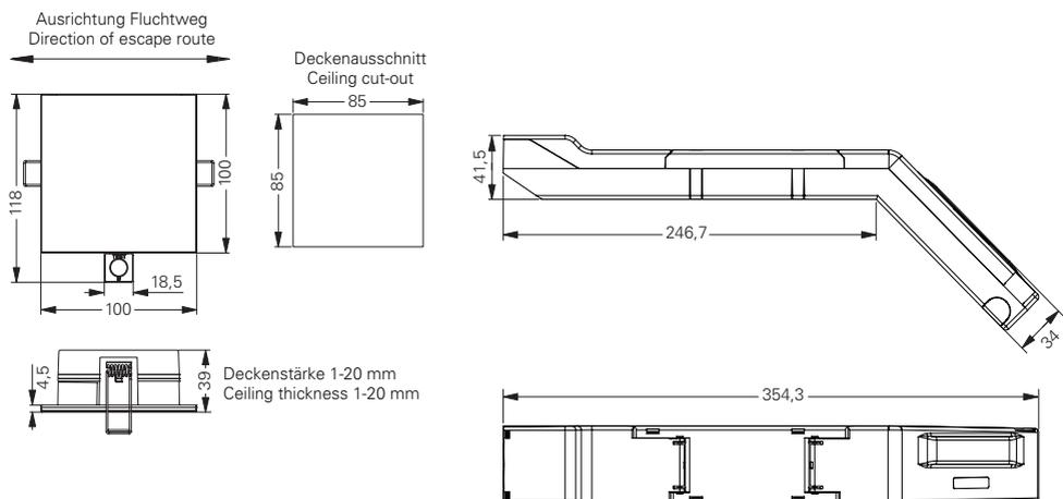
Bei Einbau durch Deckenausschnitt erforderliche Höhe in Zwischendecke: 150 mm
