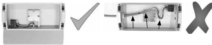
Batterie mit Leiterkarte verbinden und Abdeckung mit Reflektor auf die Leuchte aufsetzen. Dabei auf die richtige Lage des Steckverbinder am Reflektor in Verbindung mit der Anschlussklemme achten.
