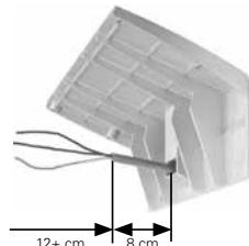
Die Leitungen dürfen nur innerhalb der gekennzeichneten Bereiche verlegt werden. Die quadratische Fläche in der Leuchtenmitte freihalten. (Details zum Anschluss siehe Kap. 3)
