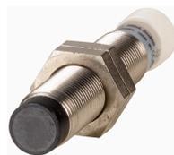
**Sensore di prossimità, M12, analogico, S<sub>n</sub>=1-8mm, 15-30VDC, 0-20mA, 0-10V, M12**
