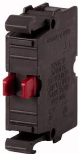
**Elemento di contatto, Morsetti a vite, Fissaggio frontale, 1 contatto NC, 24 V 3 A, solo in collegamento con M22-PV... max. 6 elementi di contatto M22-K01PV6**
