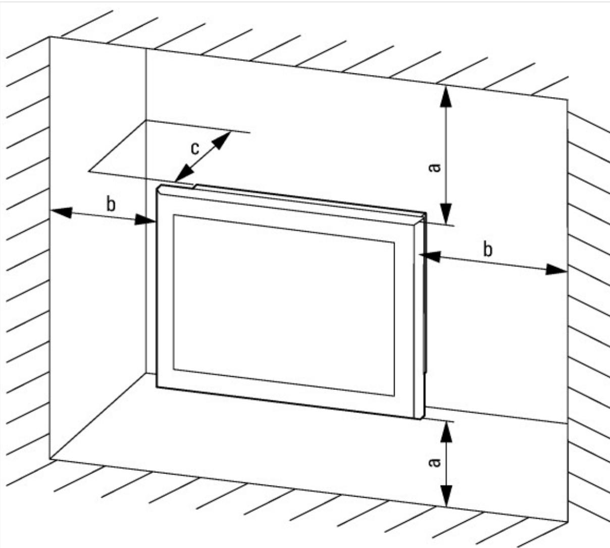
$a, b, c \geq 30 \text{ mm}, 0 \leq T \leq 50 \text{ }^\circ\text{C}$
