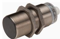
**Interruttore di prossimità, induttivo, 1 NC, S<sub>n</sub>=15mm, 4L, 6-48VDC, NPN, PNP, M30, metallo**
