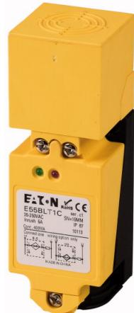
**Interruttore di prossimità, induttivo, 1NA/1NC, Sn=20mm, 2L, 35-250VAC, quad.40, materiale isolante, collegamento a vite**
