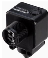
**Sensore fotoelettrico a riflessione, Sn=200mm, 4L, 10-30VDC, scuro, NPN, PNP, quad 40, materiale isolante, M12**
