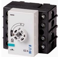
**Sezionatore di potenza, DCM, 63 A, 3 P + N (fisso), Funzione di arresto optional, senza maniglia rotativa e asse di azionamento, collegamento orizzontale**
