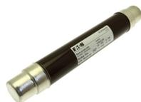
**Cartuccia fusibile, Media tensione, 20 A, AC 12 kV, 63 kA, 2", 51 x 292 mm, Back-up, DIN, con percussore**
