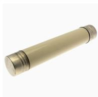
**Cartuccia fusibile in olio, Media tensione, 25 A, AC 12 kV, 40 kA, BS2692 F02, 254 x 63.5 mm, Back-up, BS, IEC, ESI, con percussore, a tenuta d'olio**
