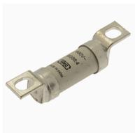
**Cartuccia fusibile, corsa rapida, 12 A, AC 690 V, DC 500 V, 200 kA, BS88, 19 x 77 mm, aR, BS**
