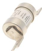
**Cartuccia fusibile, Bassa tensione, 125 A, AC 600 V, DC 250 V, 200 kA, HRCII-MISC, 38 x 112 mm, CSA**
