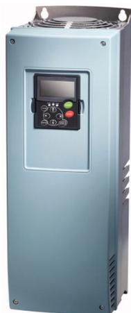
**Convertitore di frequenza, 400 V AC, trifase, 18.5 kW, IP54, Filtro soppressore radiodisturbi, Chopper frenatura, Display OLED, FR6**
