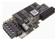
**Modulo bus di campo Modbus RS485 con morsetti a vite per convertitori di frequenza SVX ed SPX**
