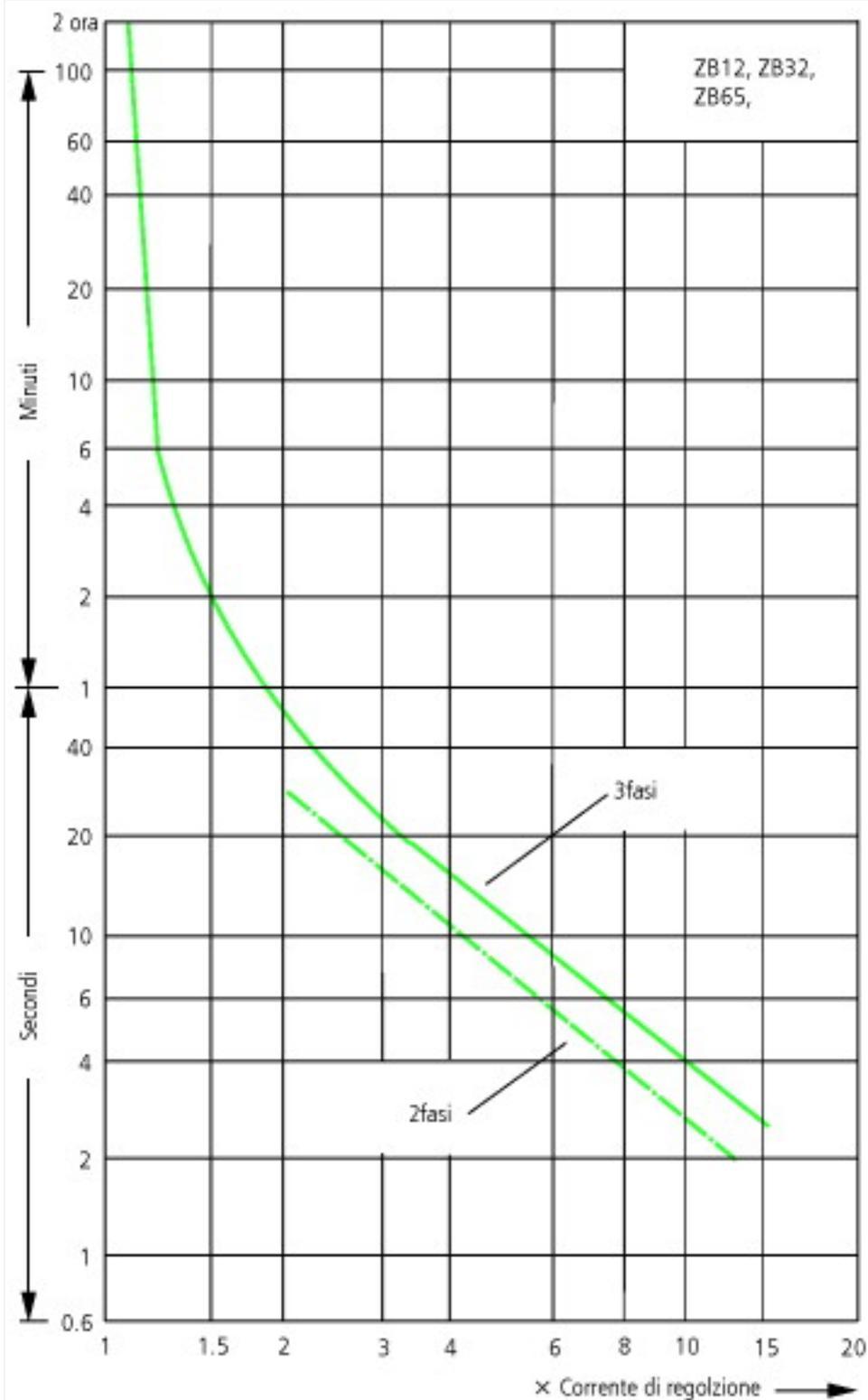
Queste caratteristiche d'intervento indicano i tempi di intervento in funzione della corrente di taratura, esse rappresentano i valori medi ricavati a freddo ad una temperatura di 20 °C. Tempo di sgancio a seconda della corrente di intervento.
